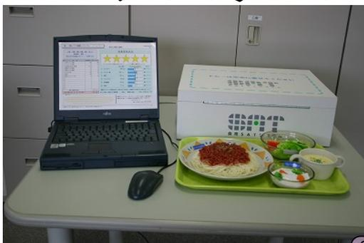
約130種類ある実物大フードモデル (ICタグを内臓) を選んでトレーの上に乗せ、センサーボックスに乗せると瞬時に接続したパソコン画面にカロリー計算・簡易判定を表示させます。
